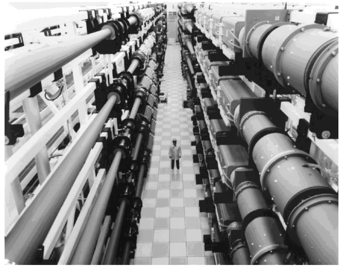
Nova : laser pour la fusion thermonucléaire, 16 TW, 2,5 ns
